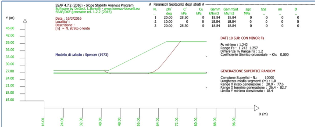
Fig. I.3: Risultato verifica utilizzando motore SNIFF-RANDOM SEARCH con segmenti medi di lunghezza 1m, assenza effetto tension cracks e metodo di calcolo Spencer (1973)
