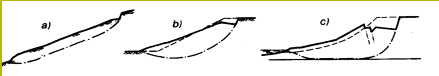
Fig. 2.2. Scivolamenti: a) di traslazione; b) di rotazione; c) composti
